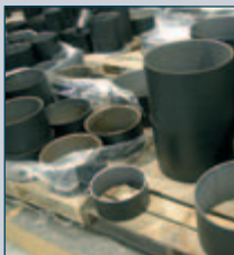
Stalen bases voor de productie van massieve banden.
