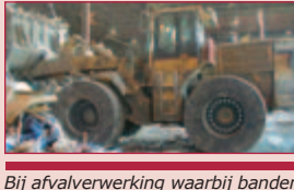
Bij afvalverwerking waarbij banden extra slijtvast (tegen o.a. metaalafval) en tegen hoge temperaturen bestand moeten zijn.
